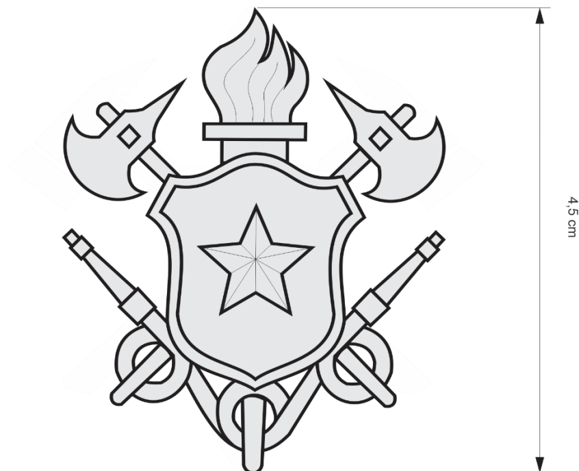
Figura 6 – Detalhes das medidas da estampa DTF – Brasão CBMERJ – Beneficiamento (tolerância \pm 0,5\text{cm} )
