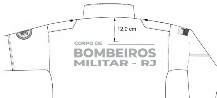
Figura 9 – Detalhes da posição do bordado costas (Tolerância \pm 0,5 cm)
