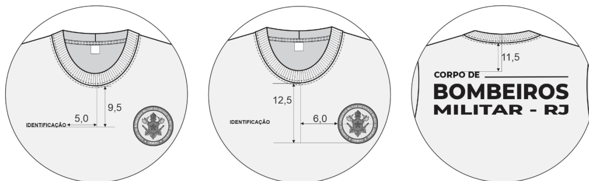
Figura 9 – Detalhes de posicionamento dos bordados da frente e da estampa das costas. (Tolerância de \pm 2\% )
