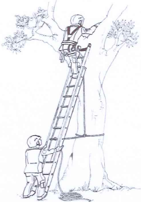
Figura 1: Técnica ascensão com escada
