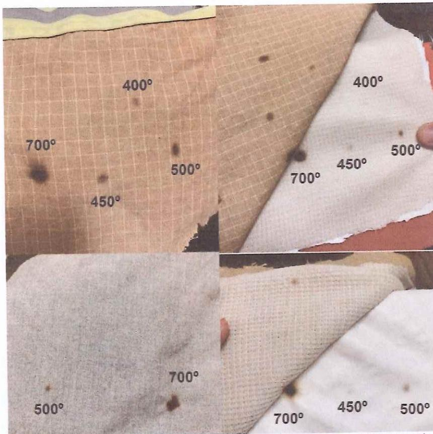
Figura 3 – Ensaio realizado com o equipamento *Glow Wire* visto nas três camadas de tecido.
