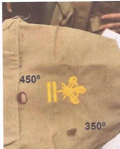
Figura 4 – Ensaio realizado com o equipamento *Glow Wire* no tecido *rip stop*.
