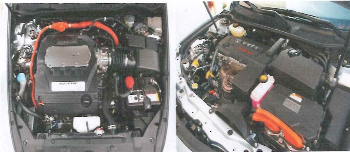
Figura 4: Presença dos cabos de cores laranja Fonte: Malutta (2017, on-line )
