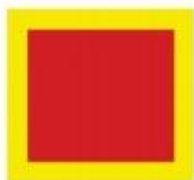
Figura 1 - Sinalização de solo para equipamentos. (hidrante e extintor)
